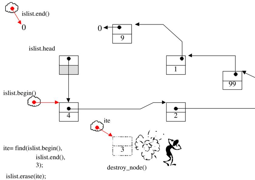
图 4-28 搜寻元素 3，并将该元素移除
