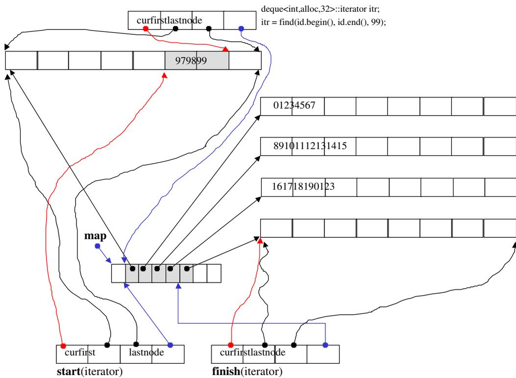
图 4-17 延续图 4-16 的状态, 以 `find()` 寻找数值为 99 的元素。此函数将传回一个迭代器, 指向第一个符合条件的元素。注意, 该迭代器的每个字段都必须有正确的设定。
