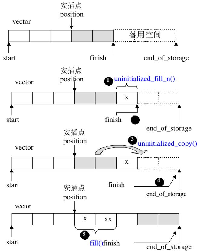
图 4-3b-2 `insert(position, n, x)` 状况 2
