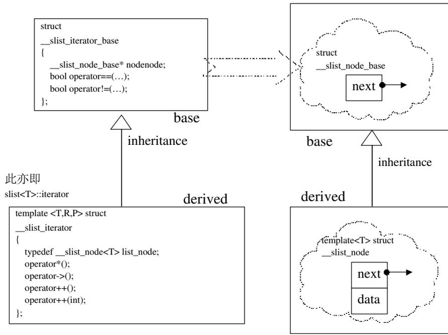
图 4-25slist的节点和迭代器的设计架构
