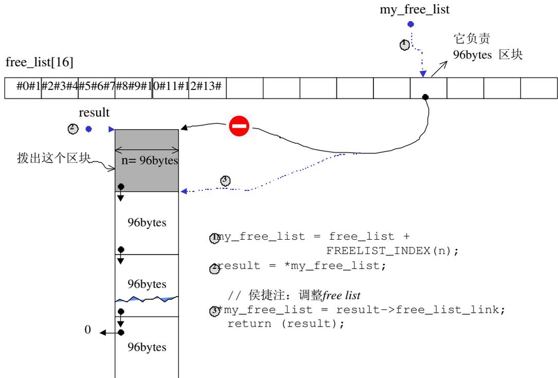
图 2-5 区块自 *free list* 拨出。阅读次序请循图中编号。
