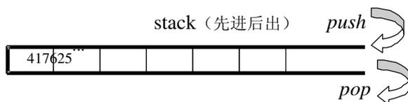
图 4-18stack的结构
