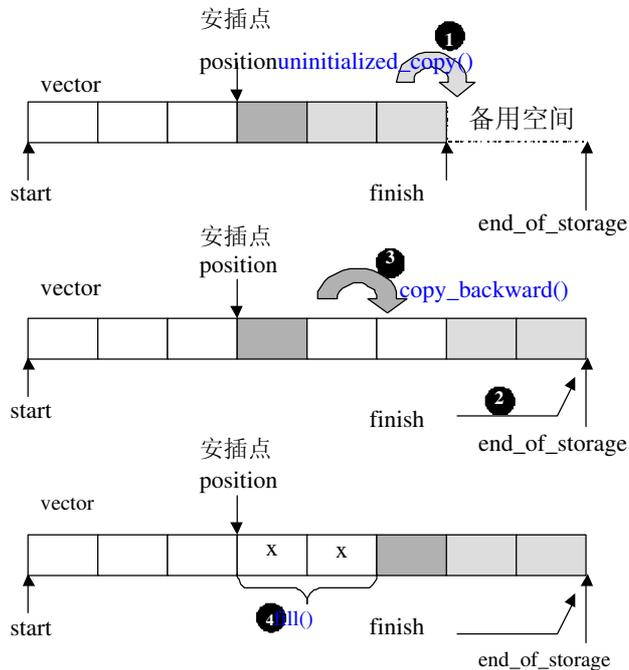
图 4-3b-1 `insert(position, n, x)` 状况 1
