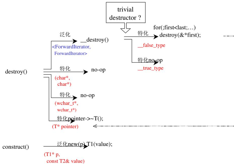
图 2-1 `construct()` 和 `destroy()` 示意。
