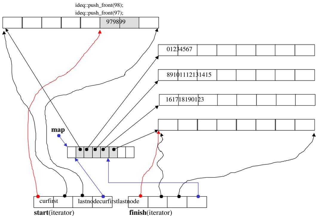
图4-16延续图4-15的状态，在最前端再加两个元素。由于第一缓冲区尚有备用空间，因此直接取用备用空间来建构新元素即可。
