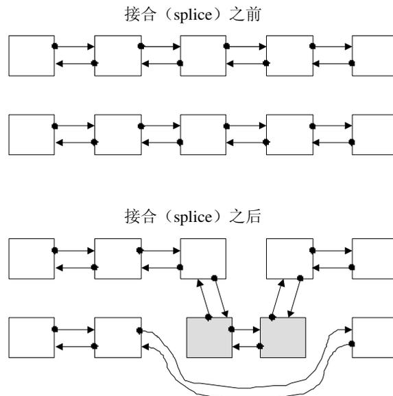
图 4-8b `list`的接合 (`splice`) 动作
