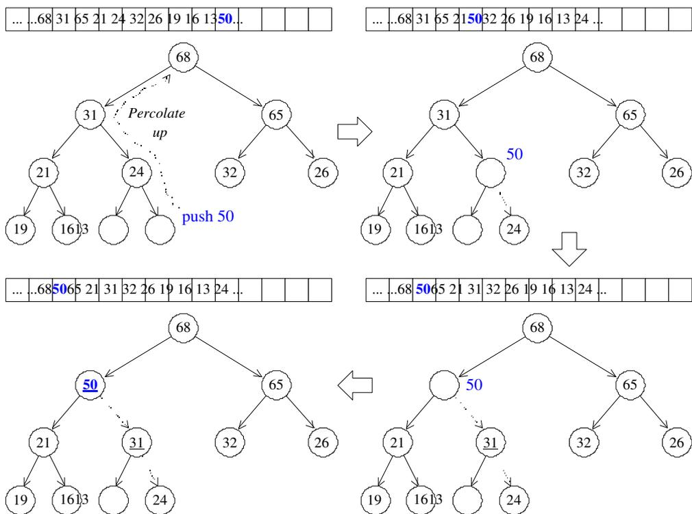
图 4-21 push\_heap算法
