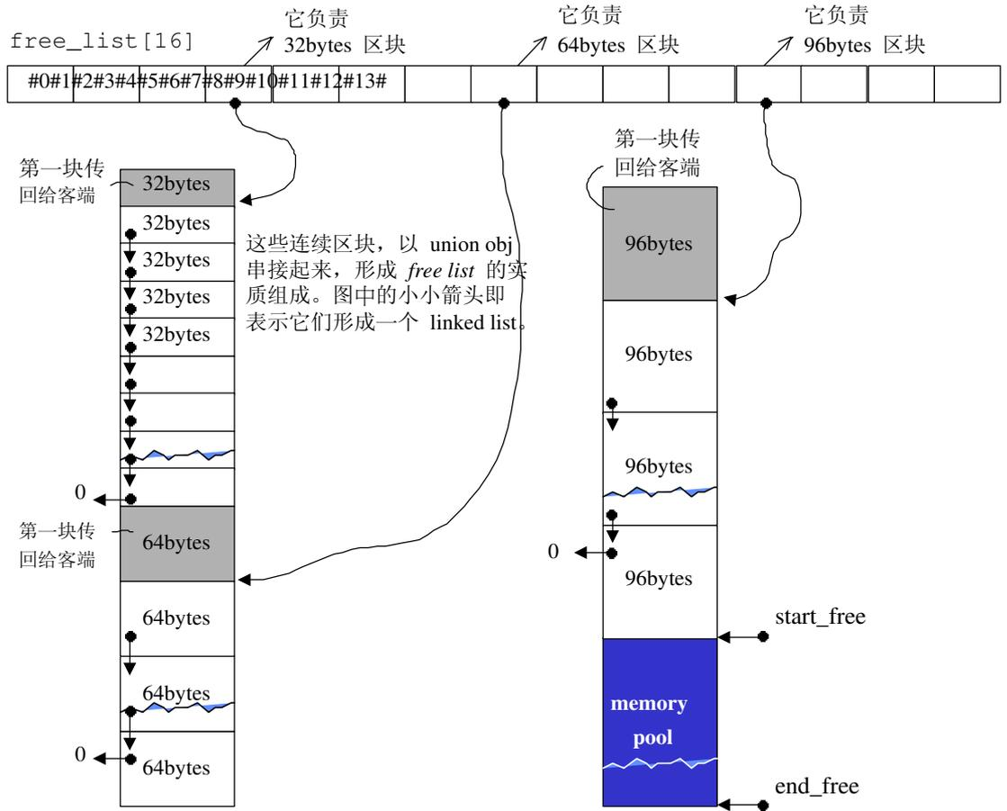
图 2-7 记忆池 (memory pool) 实际操练结果
