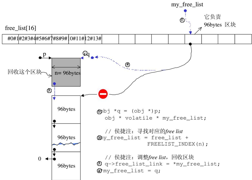
图 2-6 区块回收, 纳入 free list。阅读次序请循图中编号。
