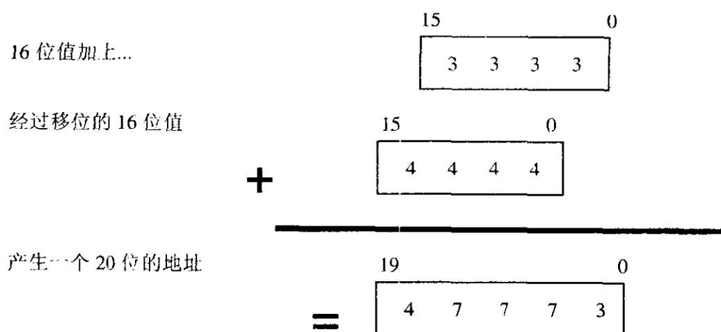
第一个 16 位值可称为“偏移量”，第二个 16 位字经过移位后称为“段”，8086 芯片有四个段寄存器，用于存储段地址的值，并能自动进入移位和加法操作来产生 20 位的地址。
