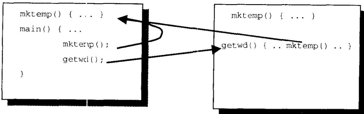
图 5-3 Interpositioning 和缺省全局域示意图
