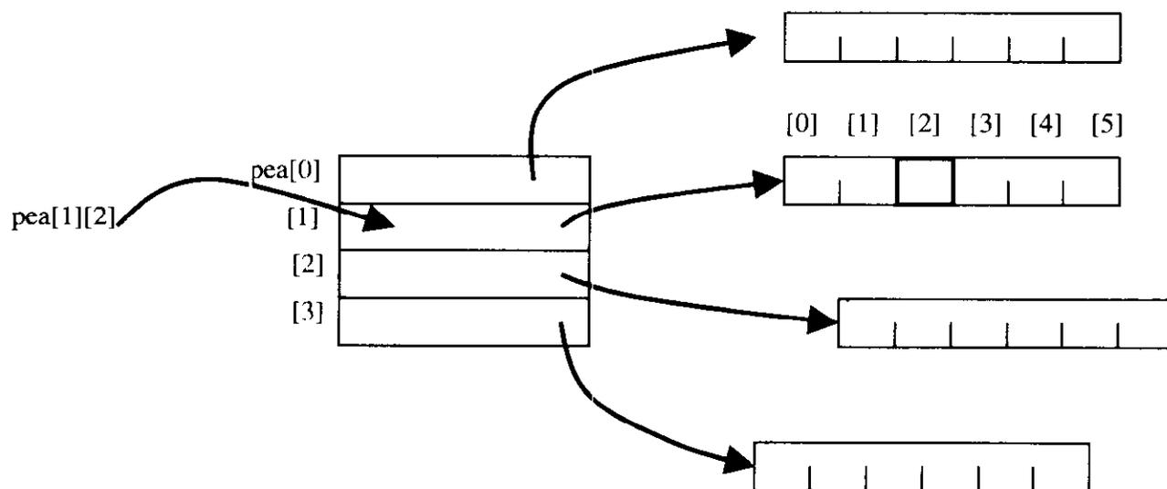
图 10-3 指向字符串的指针数组
