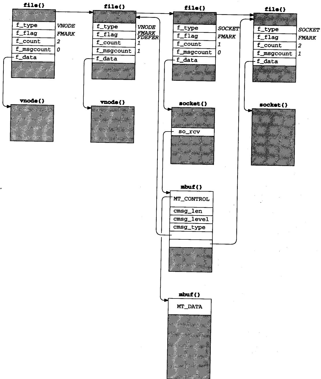
图18-17 标记阶段第一次扫描后的数据结构
