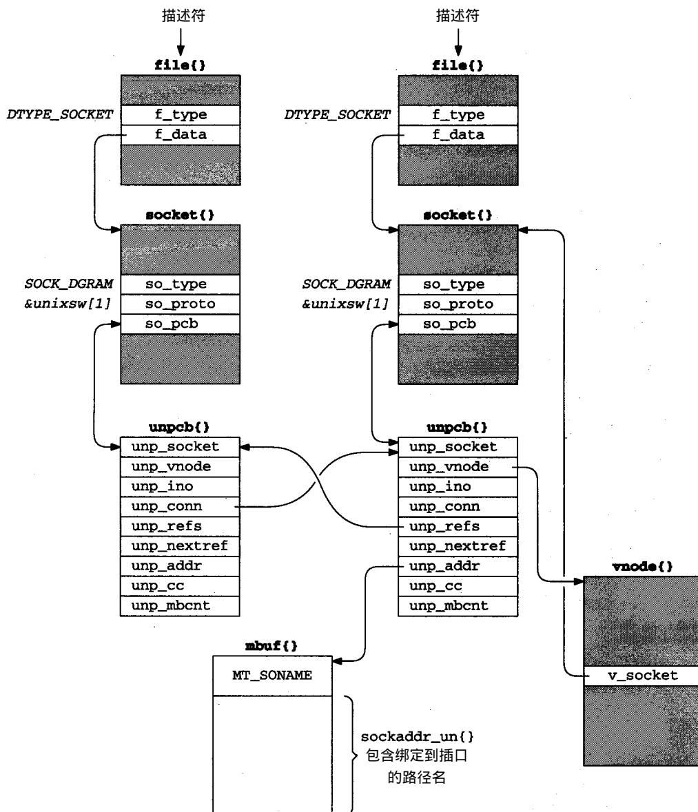
图17-9 互相连接的两个 Unix域数据报插口
