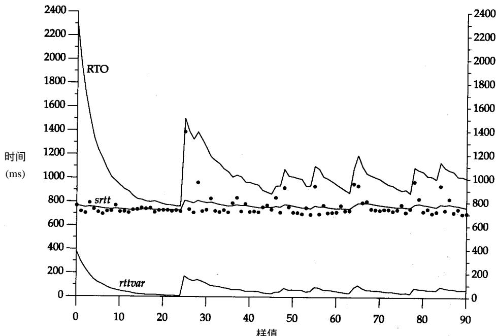
图10-6 RTT测量和对应的RTO、 $srtt$  和  $rttvar$
