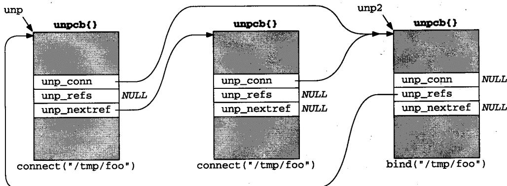
图17-25 另一个插口(左边)连接到右边的插口
