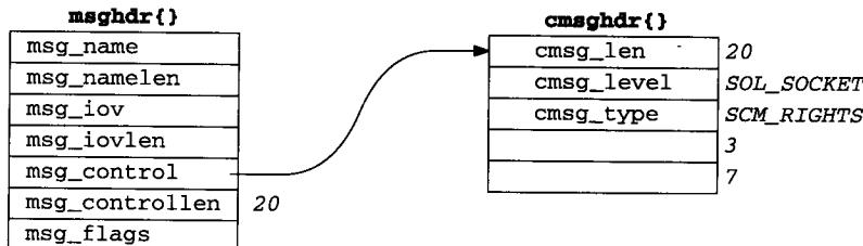
图18-8 传送两个描述符的控制信息的例子
