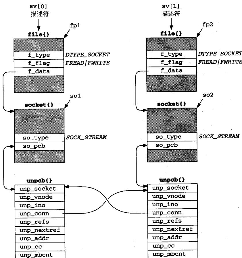
图17-28 由 socketpair 创建的两个流插口
