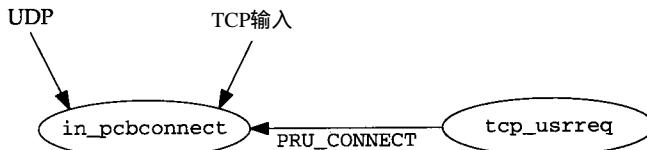
图 7-1 Net/3 中调用 `in_pcblconnect` 的小结
