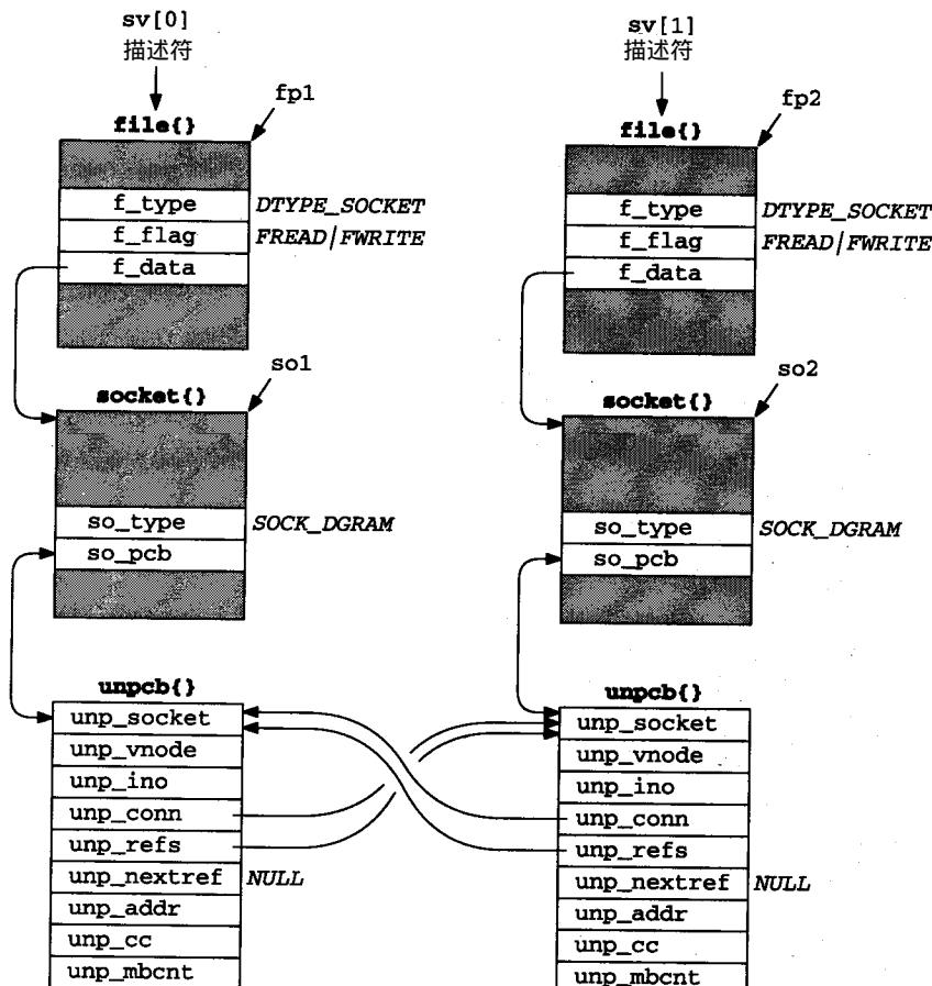
图17-29 由socketpair 创建的两个数据报插口
