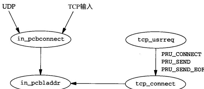
图 7-2 `in_pcblconnect` 和 `in_pcbladdr` 的新安排
