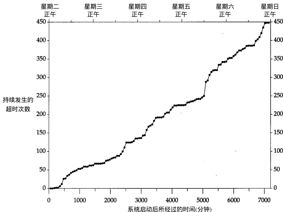
图14-18 持续探测超时后丢弃连接的数量
