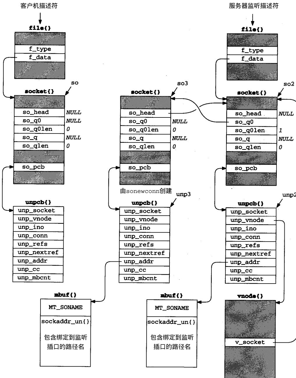
图17-20 流插口的connect 调用中的各种结构
