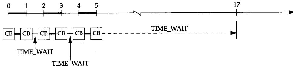
图4-3 TCP客户程序重用同一个端口号；客户和服务器主机同时支持 T/TCP 协议
